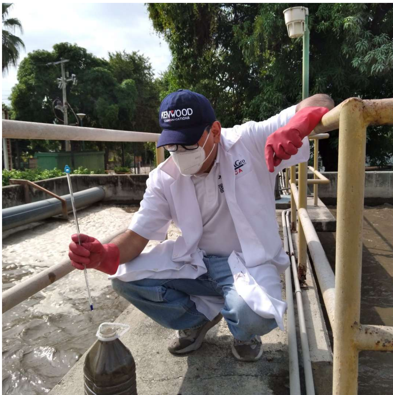
Figura 3. Recolección de muestras para la determinación de microplásticos en plantas de tratamiento de aguas residuales municipales en Acapulco. Fuente: Elaboración propia.
