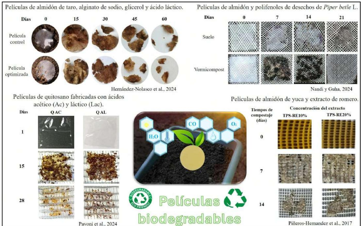
Figura 2. Aspecto visual de películas elaboradas a partir de biopolímeros sometidas a pruebas de biodegradabilidad..
